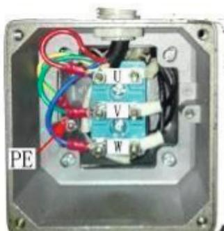
Raccordement du fil du moteur
