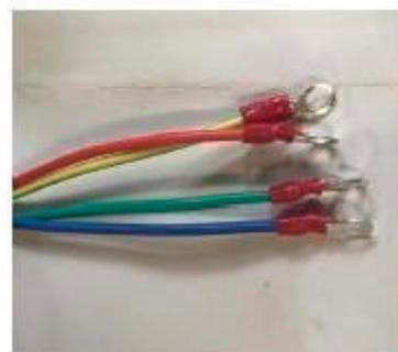
Instructions pour le raccordement du moteur (qui a été laissé à l'extérieur de l'armoire de commande) : les fils sous tension sont rouge, bleu et vert, le fil de terre est jaune et placé à l'endroit indiqué par la flèche.
